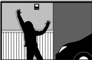
**La bouton-poussoir monté au mur doit être hors de portée des enfants,** à au moins 1,5 m (5 pi) de la surface d'appui la plus proche et à l'écart de toutes les pièces en mouvement. Montez et utilisez le bouton là où vous pouvez clairement voir la porte de garage qui se ferme.
