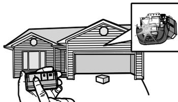
L'ouvre-porte de garage ne se fermera pas avec une télécommande si le témoin à DEL d'un des deux capteurs d'inversion de sécurité est éteint (ce qui indique que le détecteur est mal aligné ou obstrué).
